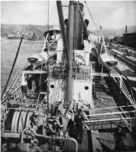
Sobre la cubierta de popa del Castillo Olmedo se puede observar, a la izquierda (babor para los marinos) la máquina de tendido de cable.
