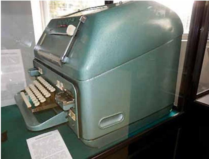
Figura 7. Teleimpresor Lorenz LO15, el primer modelo que empezó a funcionar en España. Se encuentra expuesto en el Museo “Joaquín Serna” de la Escuela.
